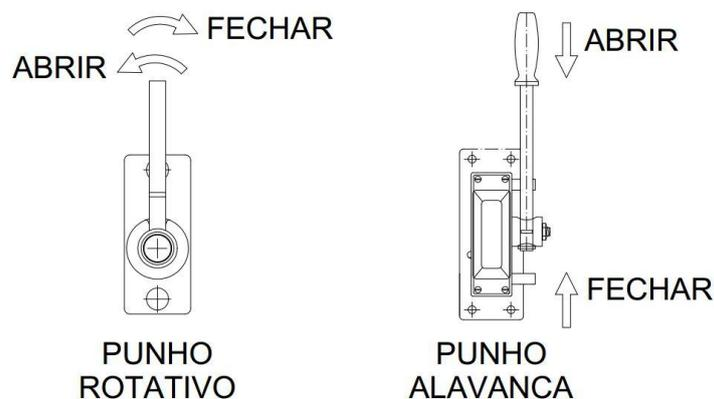
2º - Verificar e realizar o fechamento das chaves seccionadoras da instalação onde o conjunto de manobra G2-Slim está alocado.
