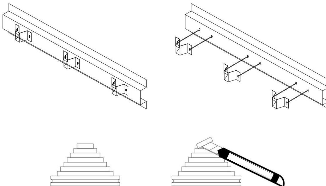
Após realizar a conexão dos cabos no interior do cubículo devem ser inseridas as abraçadeiras de modo a fixar o cabo em seu suporte, para aliviar o peso nos terminais e barramentos de conexão.
