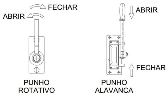
3º - Realizar a manobra de abertura das chaves seccionadoras do conjunto, seguindo a sequência numérica inversa no painel (Exemplo: Chave 4>Chave 3>...>Chave 1)
