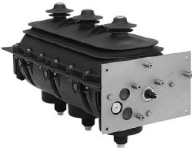
A Chave Seccionadora é do tipo isolada em SF<sub>6</sub>, possui três posições: Fechada, Aberta ou Aterrada, o que constitui um intertravamento natural que impede manobras perigosas.
