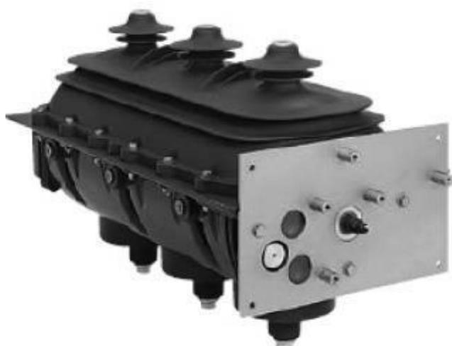
A Chave Seccionadora é do tipo isolada em SF6, possui três posições: Fechada, Aberta ou Aterrada, o que constitui um intertravamento natural que impede manobras perigosas.
