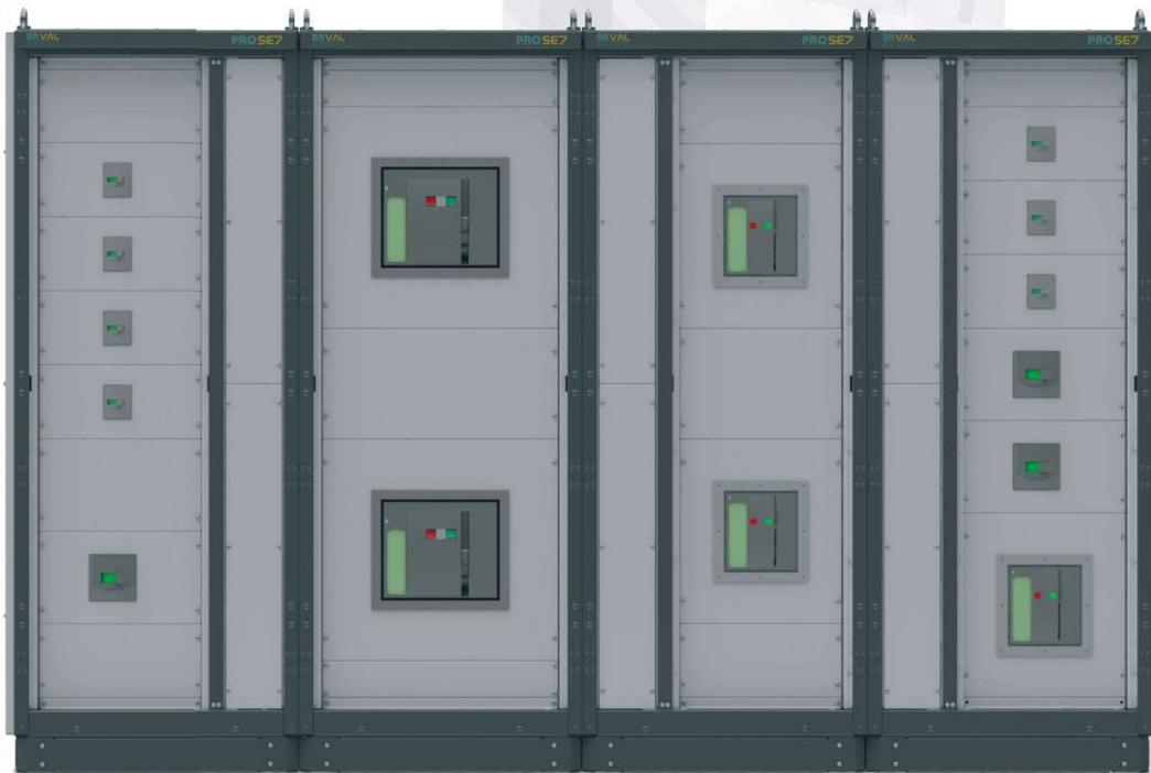
A forma como o PROSE7 foi concebido permite a instalação de até dois disjuntores de 3200A na mesma coluna, intertravados elétrica e/ou mecanicamente.
