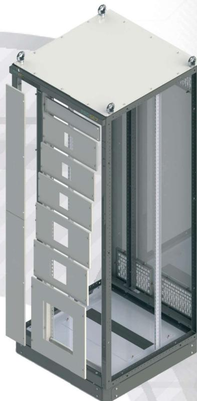
Painel construído de módulos de 50mm independentes com espaço útil de 1750mm. Permite intercambiar a posição de disjuntores e componentes.
